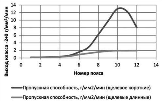
Рисунок 10. График зависимости выхода класса -2+0 мм от протяжённости щелевого отверстия.
