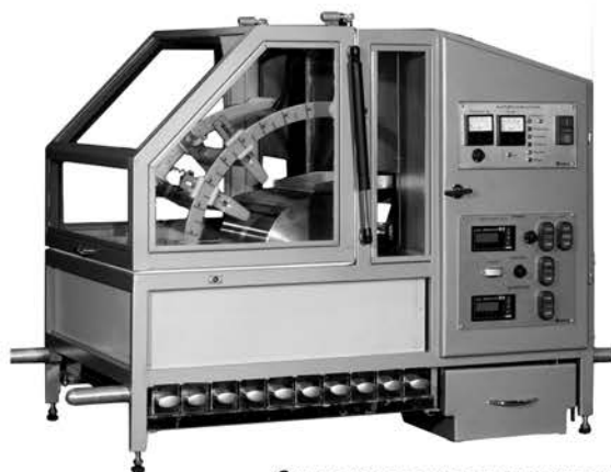
Сепаратор электростатический барабанного типа ЭЛКОР-1
