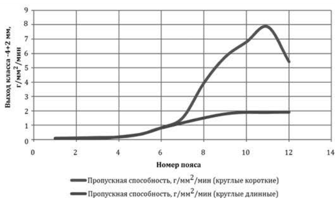
Рисунок 9. График зависимости выхода класса -4+2 мм от протяжённости круглого отверстия.
