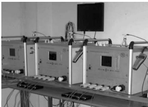
Рис. 1. Калибровочный центр, оборудованный группой генераторов ТКА-ГВЛ-01
