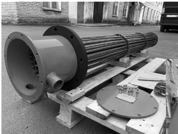
Блок для подогревания масла на 100 кВт
