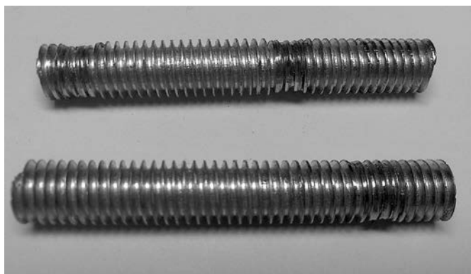
Шпилька с углом профиля резьбы 45°
